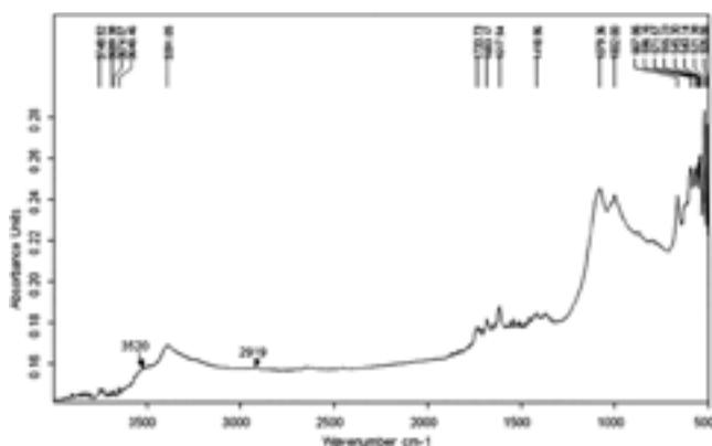
FIGURE 2.5 Jarosite body color, sample 74498, seen by FTIR. Image by Laboratorio de Análisis y Diagnóstico de Obra de Arte, Universitat de València.
